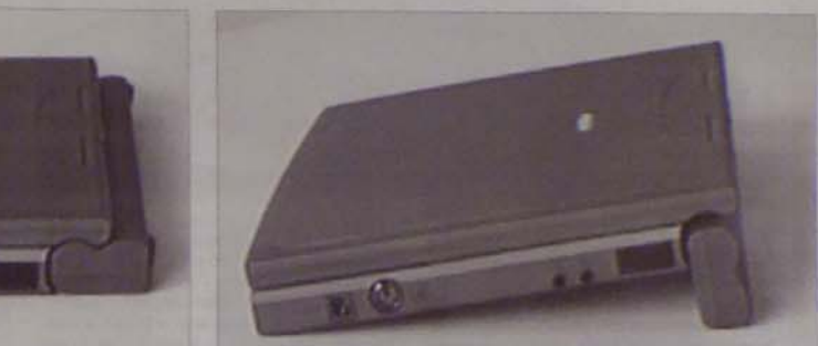
2. kép. Hátra került a HiNote Ultra akkumulátora. Így laposabb lehetett a doboz, és a billentyűzetet is feltámasztja
