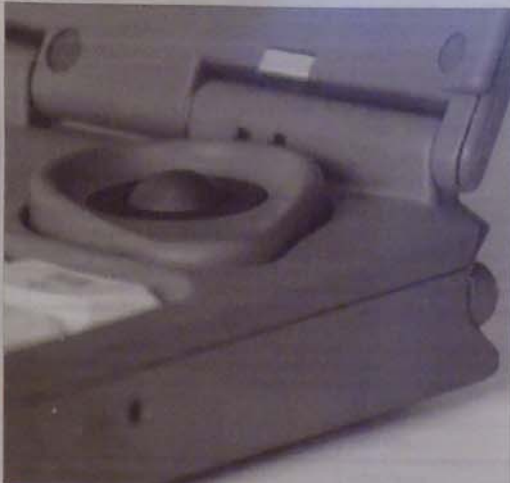
1. kép. Az Echos 24c hanyattgérnek „körtése” nem kapcsoló, bár elmozdítható. Csúpan az ujjat vezeti rá a golyóra
