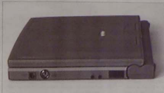
2. kép. Hátra került a HiNote Ultra akkumulátora. Így laposabb lehetett a doboz, és a billentyűzetet is feltámasztja
