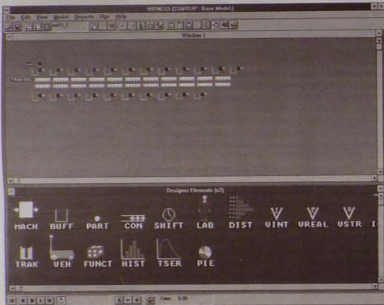
1. kép. Így fest a klasszikus, liftes példa modellje kialakítás közben. Az emeleteket tárolók képviselik, a két liftet pedig egy-egy szállítójárművet tartalmazó pályák
