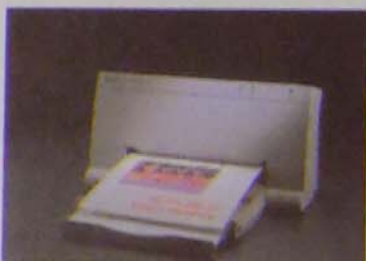
2. kép. Ha nem nyomtatunk éppen a HP DeskJet 400-ossal, felhajtható az első tálcája; kisebb helyen tárolható
