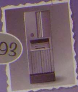
ZebraServer 5 DVX szerver 1x40 MHz CPU, 64 MB RAM
