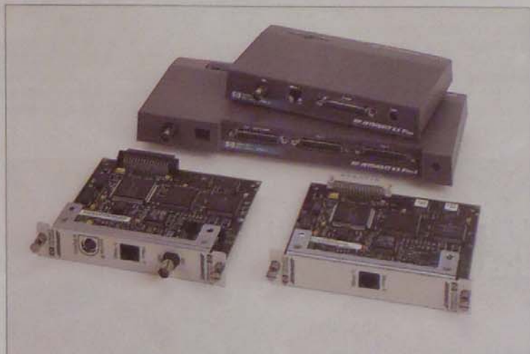
A HP JetDirect hálózati nyomtatócsatlakozó termékcsaládjá kétféle külső és kétféle belső (nyomtatóba szerelhető) termékből áll
