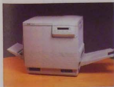
1. kép. A négy festéktartály és a bonyolultabb képkészítési mód teszi kissé terjedelmesebbé a Tektronix Phaser 560-as színes lézernyomtatót
