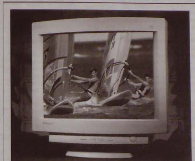
Energiatakarékos, Win95-kompatibilis - Plug & Play+ - az Optiquest (ViewSonic) V95 típusú, 19 hüvelykes monitora, amelynek képsőve függőleges irányban egyenes. A hozzá hasonló, nagy teljesítményű - nagy felbontású, kiemelkedő vizuális élményt nyújtó - monitorok lassan a közönséges irodákba is bevonulnak
