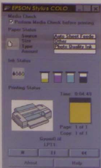
11. kép. Talán a Stylus Color 3000-es állapotfigyelője nyújtja a legtöbb információt a nyomtatóról
