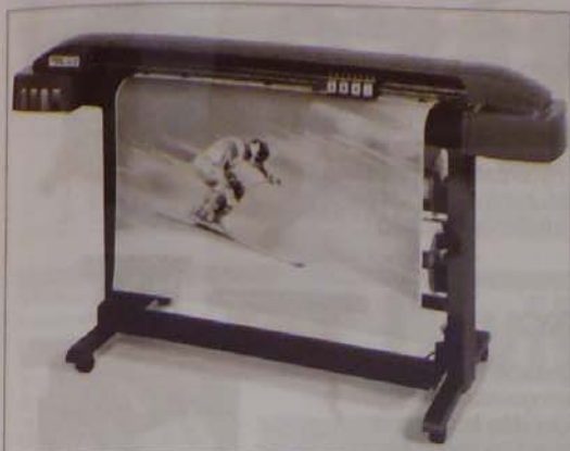
15. kép. A tekintélyes méretű ENCAD NovaJet Pro 42e bal oldalán látható, mennyi festék van a tartályokban
