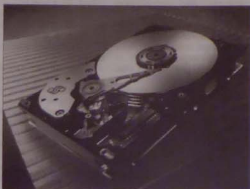
A Seagate Cheetah meghajtója 10000-et fordul percnként, kapacitása 4,5 vagy 9,1 gigabájt. Csatlakozófelülete Ultra SCSI-2 vagy FC-AL (Fibre Channel-Arbitrated Loop)
