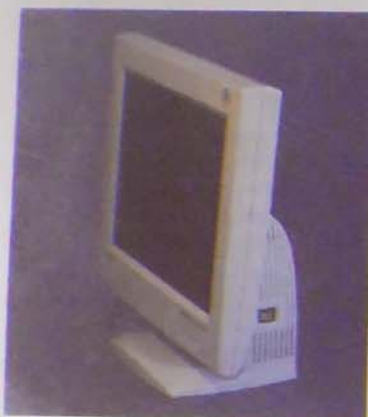
9. kép. A kis NEC a puttönyában hordja a tápját
