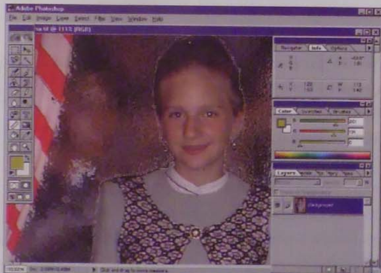
4. kép. Mágneses körülrajzolás és mérési lehetőségek (a függőnyél a kurzor mellett) a Photoshopban
