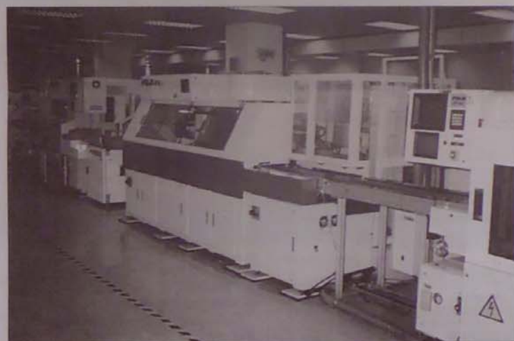
1. kép. Alaplapszerelő gépsor részlete; az egységek közti sínen haladnak az alaplapok. Az árboclámpákon távolról is áttekinthető a folyamat állása, a nyílt helyek némelyikén személyes ellenőrző munkahely van (Kapok)
