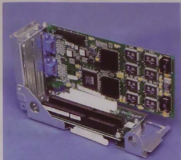
1. kép. A Jeronimo Pro megjelenítő-kártya a kézzel eltávolítható kiemelőkártya egyik helyét foglalja el
