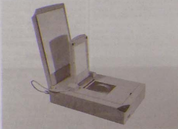
4. kép. Az Epson ablakába egy kis átvilágító helyezhető
