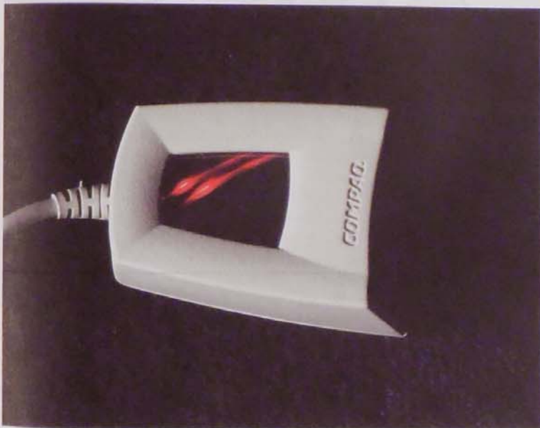
1. kép. A kis leolvasóegység; ujjunkat festékpárna helyett az ablakra kell nyomni
