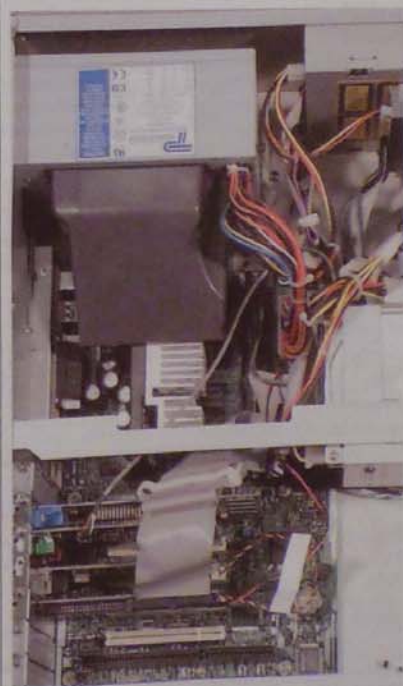
1. kép. A Gateway E4200 belsejében közös a processzor és a tápegység hűtése
