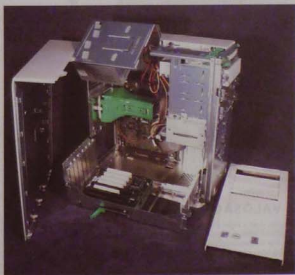
1. kép. A leemelhető zöld légtérrel mögött bújkál meg az 550 megahertzes Intel Pentium III processzor
