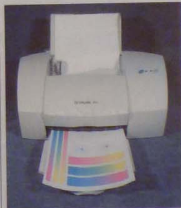
4. kép. A Lexmark Z51 maga elé helyezi az elkészült oldalakat (ezen az egyenesebb utat vastagabb papírok is végigjuthatják)
