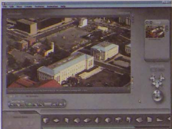
1. kép. A MetaCreations Canoma munkafelülete. Alul láthatók a térbeli modell építéséhez használható elemi testek
