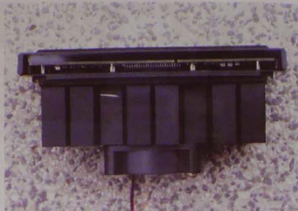
4. ábra. Processzor alulnézetben, természetes hűtőbordával
