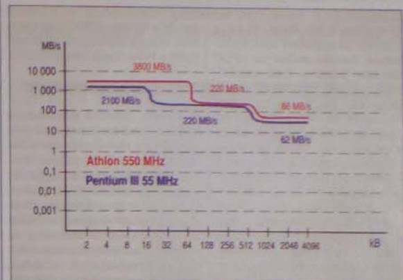
6. ábra. Többszöri adatblokkbeolvasások eredménye csomag (burst-) átvitel nélkül
