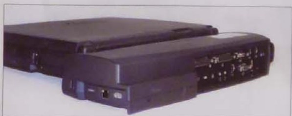
Egy példa a noteszgép dokkolására: balra az Ethernet hálózat aljzata, hátul a teljes csatlakozókészlet
