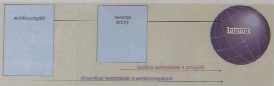
4. ábra. Fordított (reverse) helyettesítő kiszolgáló alkalmazása
