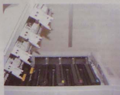
3. kép. Felül a négy LED-sor, alatta a négy festék-tartó a szelénhengerekkel
