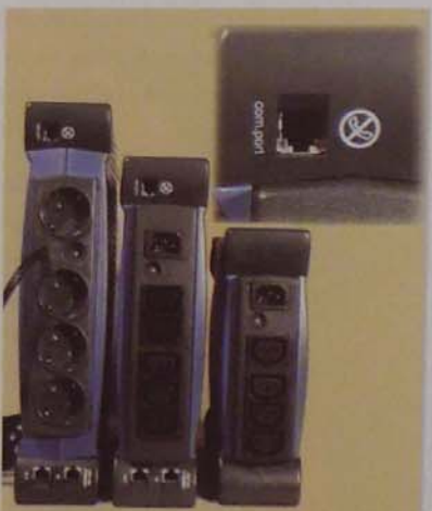
2. kép. A három méret, különböző hálózati csatlakozókkal. A kinagyított rész nem modemsvédő, az az RS 232 csatlakozó!
