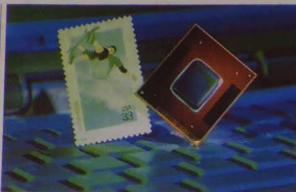
4. kép. Mobil Pentium III processzor BGA tokozásban
