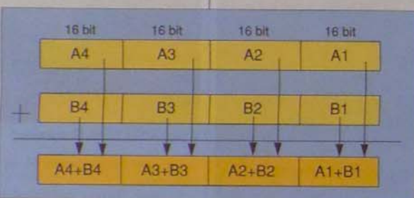
1. ábra. Négy számpár összeadása egyetlen SIMD művelettel
