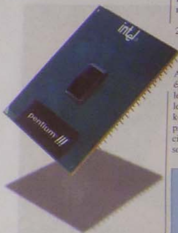
3. kép. A PIII új FCPGA tokozása
