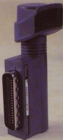
5. kép. Az ötletes infra csatlóegység a párhuzamos (Centronics) csatlakozási felülettel
