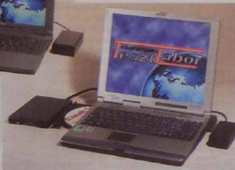
2. kép. A Fujitsu Siemens Lifebook S Series noteszgép a megjelenítő alatt találjuk az állapotjelző LCD sort
