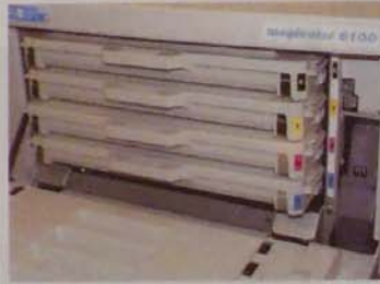
6. kép. A Minolta/QMS festéktartói egymás fölé vannak állítva
