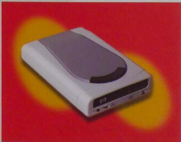
2. kép. A legömbölyített ház és a kímélőablak, az USB-s HP CD-Writer 9510i külsőjének két jellegzetessége
