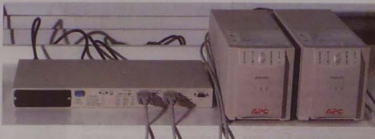
1. kép. Az átkapcsoló működés közben, két APC BK700-assal
