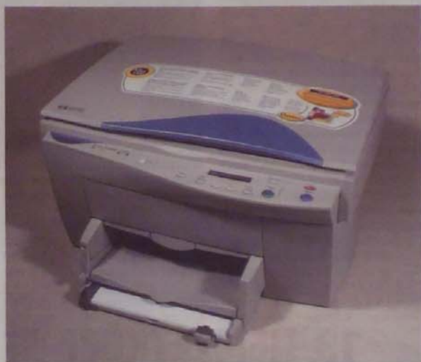
1. kép. A HP PSC 500-ban alul a nyomtató, felette a síkgyáras lapolvasó
