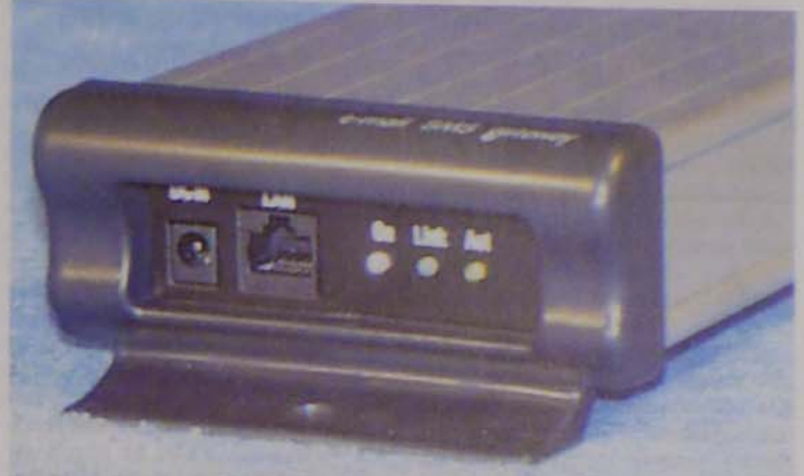
Az SMS-Gateway három dologra vágyik: tápellátásra, hálózati csatlakozásra és térerőre
