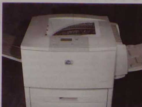
A közel kocka alakú HP LaserJet 9000dn-ből jobbra a kézi adagoló, balra az egyik kimeneti tálcá „lóg ki”
