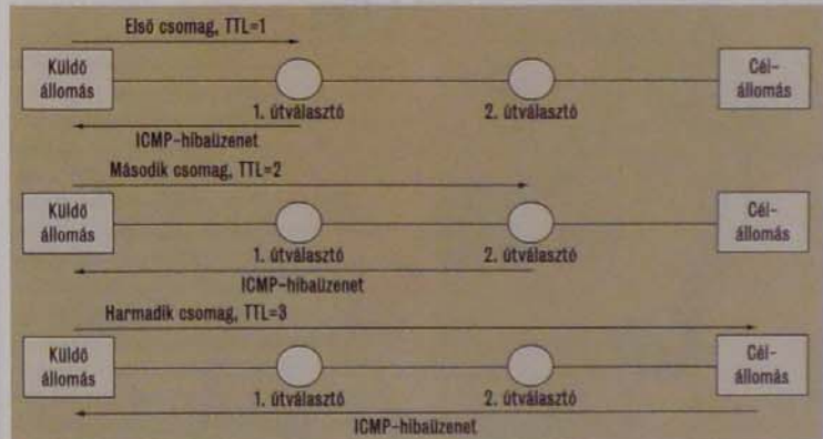
4. ábra. A traceret segédprogram működése
