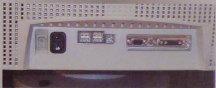
A jobb szélső a speciális 13W3C csatlakozó
