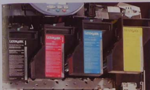
↑ kép. Egymás mellett a négy nagy kapacitású festéktartály, s aljukba építve a négy szelvényhenger
