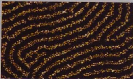
A Chicago University laboratóriumában önszervezéssel létrehozott arany nanoláncok
