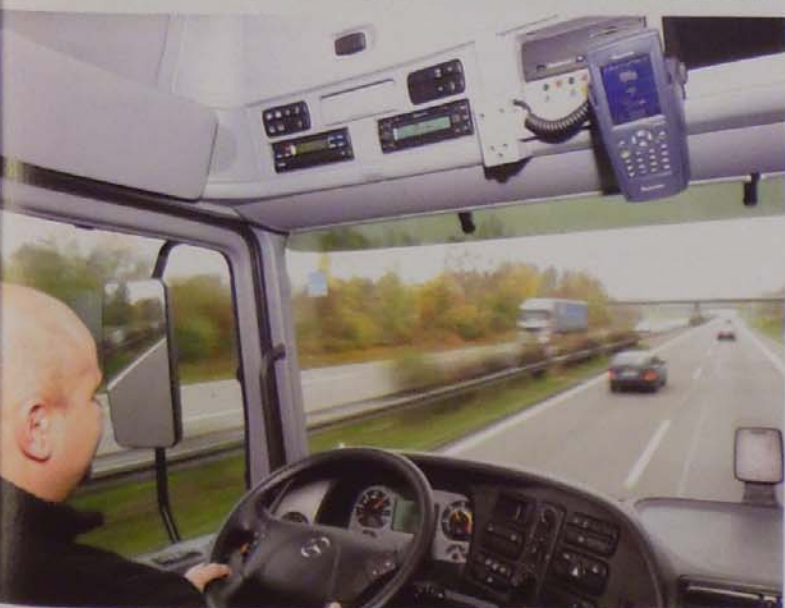
Mercedes Actros kamionbelső DispoPilot fedélzeti számítógéppel (Jobbra fent)
