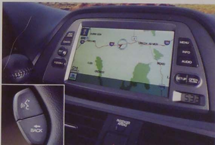
A 2005-ös Honda Odyssey műholdas navigációs rendszere a felolvasó funkciót aktiváló gombbal
