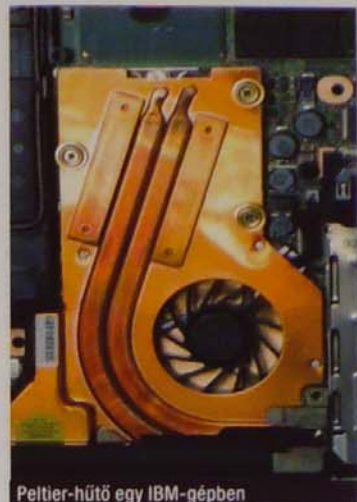
Peltier-hűtő egy IBM-gépből
