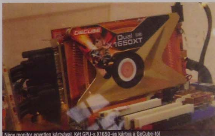
Négy monitor egyetlen kártyával. Két GPU-s X1650-es kártya a GeCube-tól
