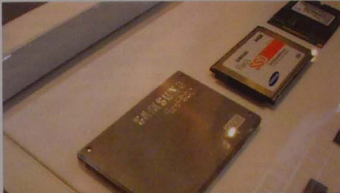
A Samsung 64 gigabájtos, Solid-State – vagyis mechanikus alkatrész nélküli – meghajtói. 2,5, illetve 1,8 hüvelykes méretben, PATA illesztővel. A háttérben a tokozatlan elektronika
