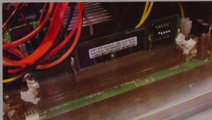
Ilyet sem sokat láthattunk még: DDR3 memóriamodulok munkában, szintén a Samsung standján. Érdekeség, hogy a noteszgépbe való SO-DIMM modulok átalakítóval illeszkednek az asztali gépbe való alaplapba
