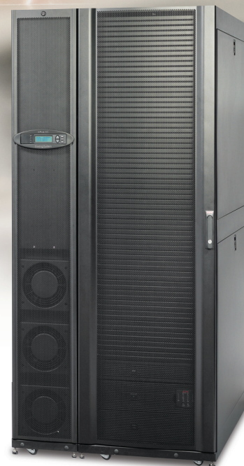
Az APC rackalapú hűtési rendszere a meleg levegőt hátul szívja be, a hideg levegőt pedig elől fújja ki, így az máris átkerülhet a mellészertelt rackekbe.
