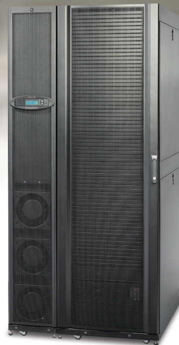
Az APC rackalapú hűtési rendszere a meleg levegőt hátul szívja be, a hideg levegőt pedig elől fújja ki, így az máris átkerülhet a mellészerelt rackekbe.
