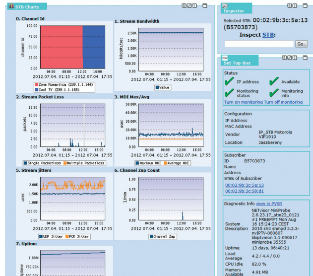
3. ábra. Előfizetői set-top box által végzett mérések az iTVsense rendszerben
