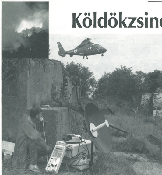
Képvonkón az Inmarsat-A szárazföldi mozgó terminál, használat közben
