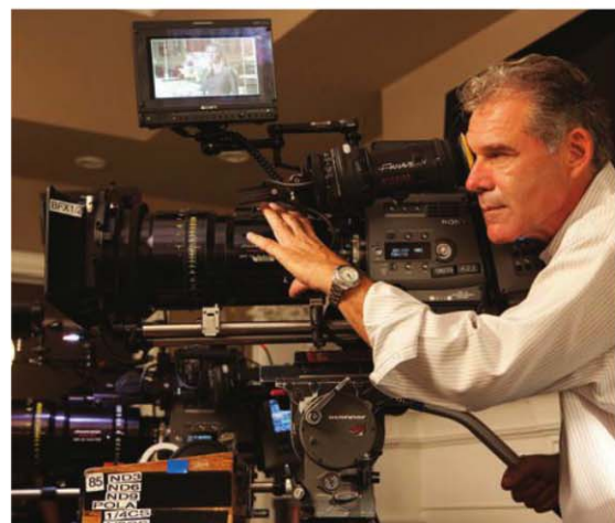
Bagdonas időnként az új OConnor 120EX fejre vált, különösen a súlyos zoomlencsék esetén. Ám a fej nagy teherbírása ellenére, mégis kis tömeg érzetet nyújt.
