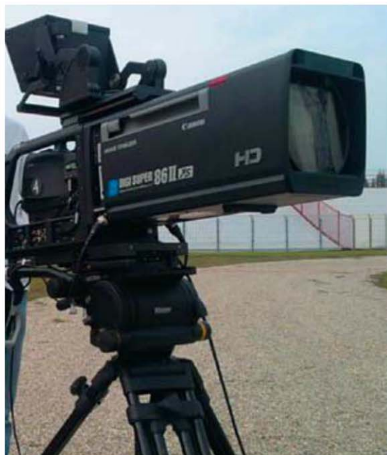
Grass Valley LDK 8300-as Live Super SloMo kamera, 86x képstabilizátoros, HD optikával
