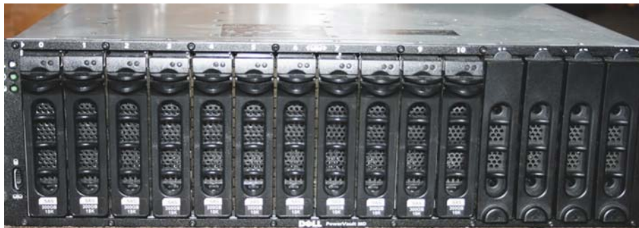
Dell 3,3 TB-os tároló RAID 5 konfigurációban
