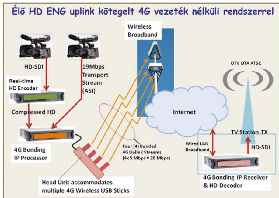
A JVC HD ENG kötegelte 4G uplink rendszere
