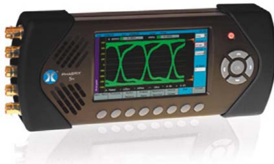
PhabrixSxE - videó mérőműszer, eye-pattern és jitter mérési lehetőséggel
