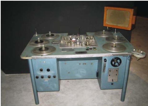
Steenbeck vágóasztal. A filmgyárban sok ilyen készítettünk a '70-es évek végén tartalék alkatrészekből
