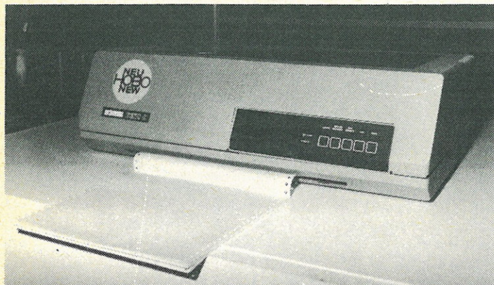
Az Izot 6311C típusú margaréta-kerekes mikronyomtató
