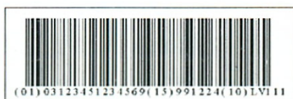
A példa szerinti EAN/UCC-128 vonalkód GTIN-t, minőségmegőrzési határidőt és gyártási tételszámot ábrázol
